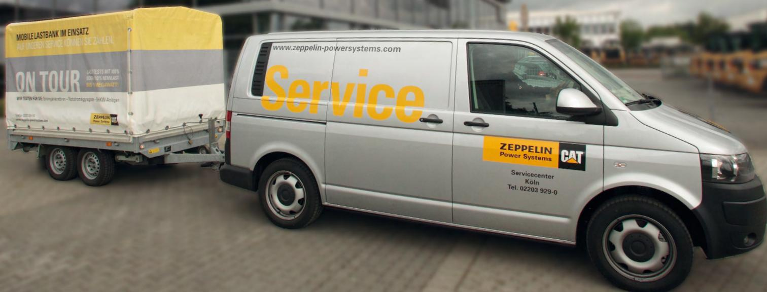
Ab sofort bietet der Kundendienst von Zeppelin Power Systems die Mobile Lastbank zur Lastprüfung Ihrer Generatoranlagen mit einer Leistung von bis zu 1 MW an. Damit können Anlagen aller Hersteller getestet werden.
