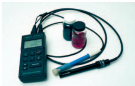
Messgerät für Leitfähigkeit und pH-Wert
